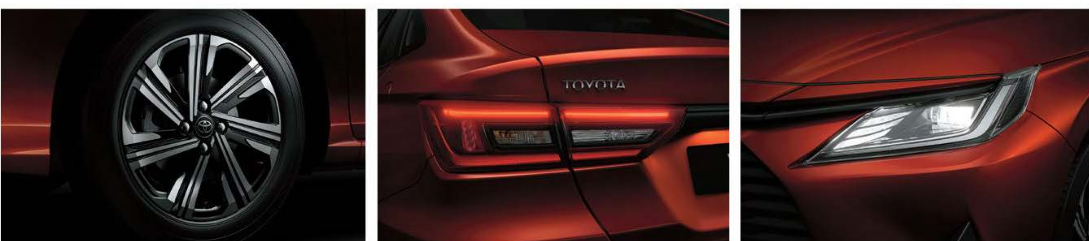
١. مصباح أمامي LED ٢. مصابيح خلفية مدمجة LED ٣. عجلات ألومنيوم مقاس ١٦ بوصة 1. LED Head Lamp 2. LED Rear Combination Lamp 3. 16-inch Aluminum Wheel
